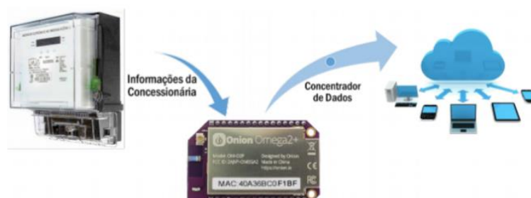
Figura 1: Esquema básico da comunicação de dados medidor-interface-nuvem
